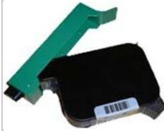
Der Refill-Clip mit seiner speziellen Gummidichtung erlaubt ein Nachfüllen der Kartuschen über den Druckkopf. **Merke:** Der Clip ist zur Befüllung, Reinigung und Entlüftung der Kartuschen, nicht aber zur Lagerung der befüllten Kartuschen geeignet, da er den Druckkopf nicht luftdicht abschließt. Die Patrone mit dem Druckkopf in Richtung Einfüllstutzen des Refill-Clips einsetzen.
